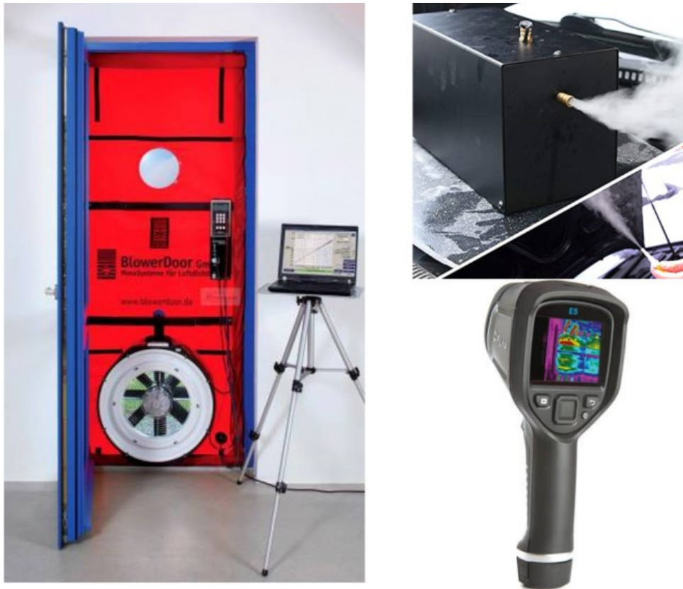
Mynd 1: Dæmi um búnað sem þarf til loftþéttleikamælingar á verkstað.
