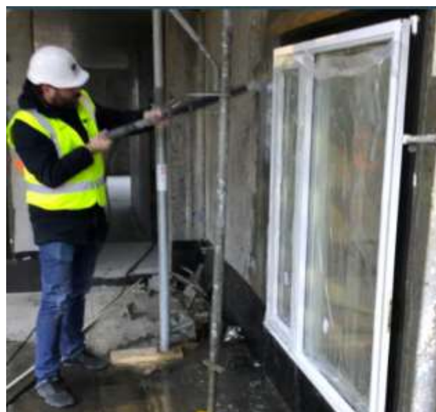
Mynd 3: Dæmi um framkvæmd slagregnsprófs á verkstað.
