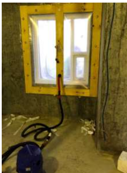
Mynd 2: Dæmi um framkvæmd slagregnsprófs á verkstað.
