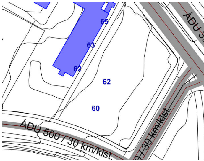
MYND 4 Gamli Garður, fyrir uppbyggingu, hæsta hljóðstig við húshlið og hljóðstig á útisvæði.
