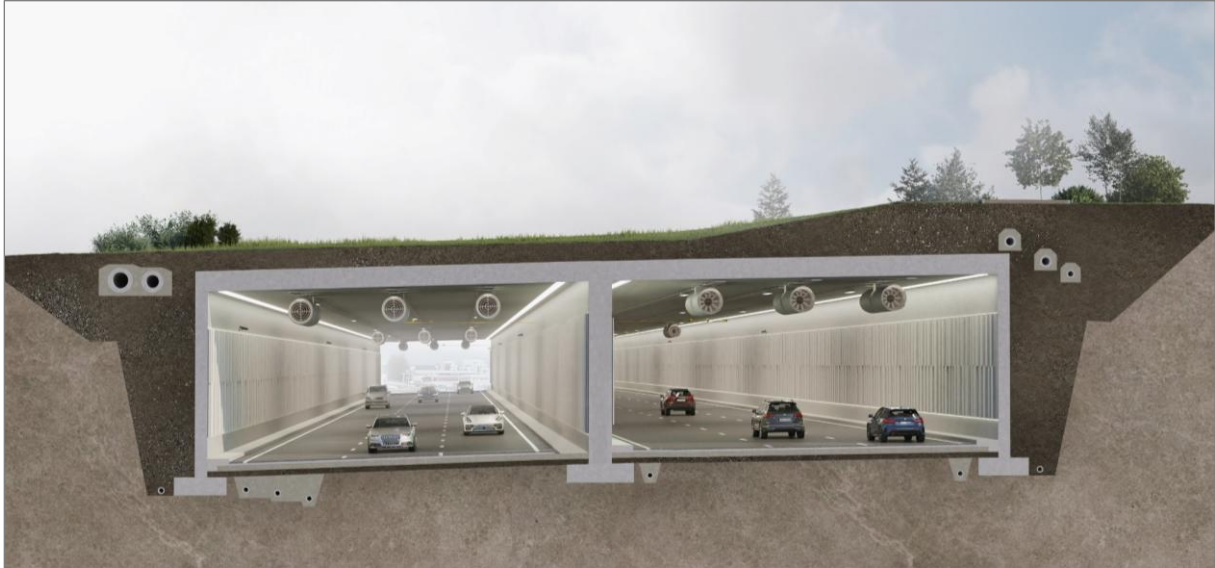
Mynd 1.2 Þversnið í tvískiptan stökk á Sæbraut með tveimur akreinum í hvora átt og blöndunarreinum.
