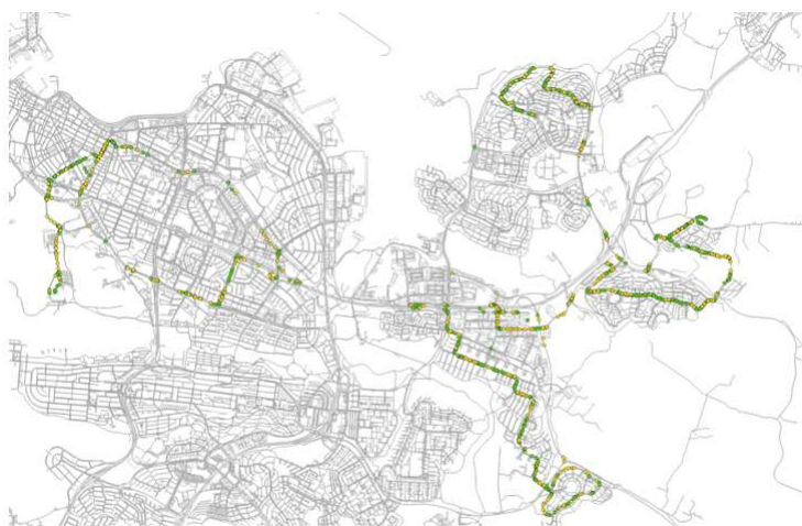
Mynd A.5: Skráðir punktar í raugögnum fyrir leið 5 og 18 þar sem hraði var á bilinu 25 til 35 km/klst. Gulir punktar voru á bilinu 30 til 35 og grænir punktar á bilinu 25 til 30 km/klst.
