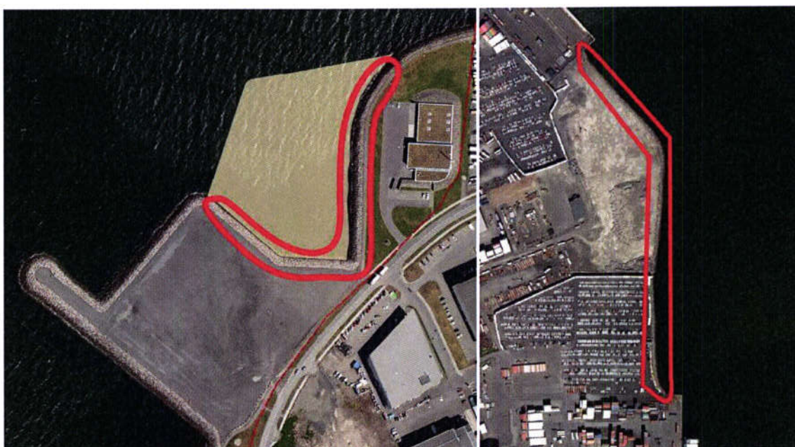
MYND 2.8 Hér er búið að merkja inn þá grjótvörn sem hægt er að endurnýta, annars vegar við Klettagarða (t.v.) og hins vegar milli Sundabakka og Vogabakka (t.h.).
