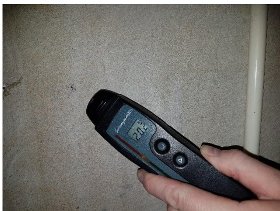
Mynd 23 Valið var að setja mæla í bil sem mældust þurr með snertirakamælum til að fá samanburð við bil sem mældust rök. Gluggi 3, 4. hæð milli glugga
