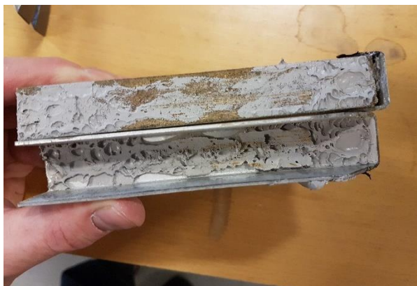
Mynd 15 Mynd sýnir óþéttleika kittunar þar sem hún er ekki nægilega þétt í skúffu, loftmyndun í kitti og ummerki um að ekki sé nægilegt kitti í samskeytum horna til þess loftþétta.
