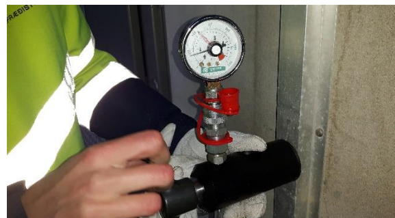
Mynd 32: Framkvæmt var togþolspróf á skrúfum í miðjuleiðurum. Skrúfur voru allar vel fastar og hafa góða festu í gömlu festigötunum.
