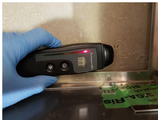
Mynd 24 Valið var að setja mæla í bil sem mældust rök með snertirakamælum til að fá samanburð við bil sem mældust þurr. 5. hæð gluggi 1 milli glugga
