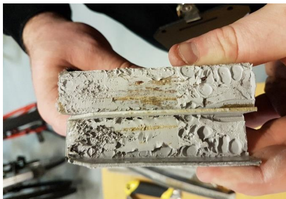
Mynd 16 Mynd sýnir óþéttleika kittunar og loftmyndun í kitti. Ekki er hægt að segja að það sé lokaður endi á þessari plötu.
