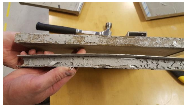
Mynd 12 Mynd sýnir þegar búið er að fjarlægja u-skúffu af plötu og sjá má kittun í botni skúffu sem virðist heldur óþétt og mikið af loftbólum sem myndast hafa í kittinu.
