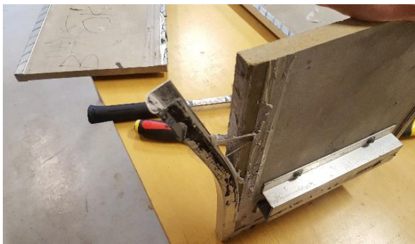
Mynd 11 Byrjað að fjarlægja u-skúffu af neðrihluta Viroc plötu.
