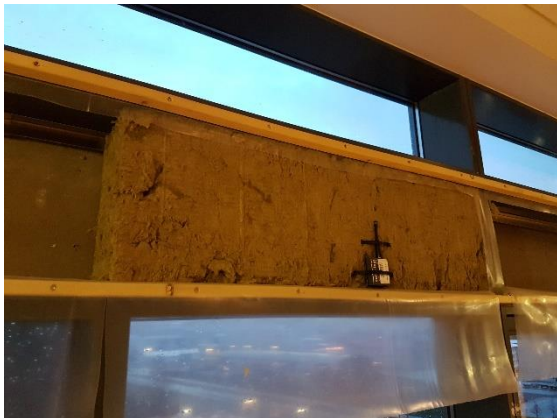
Mynd 29 Rakamælar settir í bil. Einn sem snýr að Viroc plötu og annar sem snýr inn, bak við rakavörn
