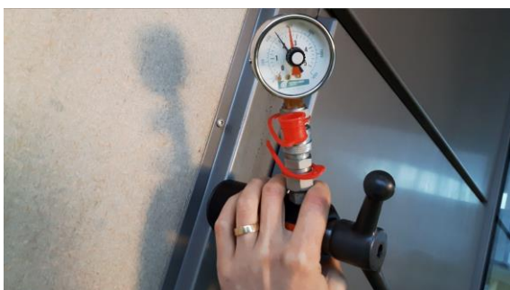
Mynd 33: Framkvæmt var togþolspróf á skrúfum í nýjum götum í endaleiðurum. Skrúfur voru vel fastar ar við prófið og hafa gott togþol m.v. hönnunarálág.
