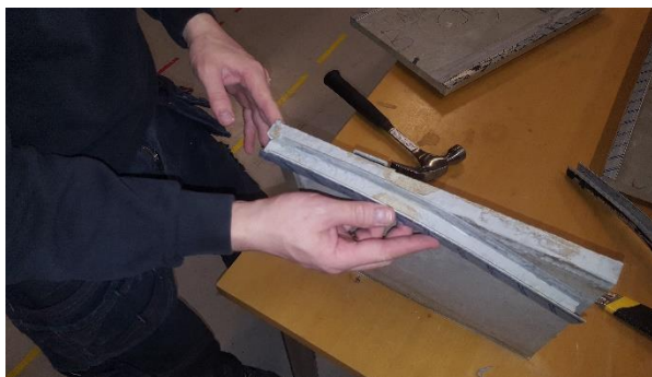
Mynd 13 Mynd sýnir þegar búið er að fjarlægja u-skúffu af efri hluta viroc plötu.
