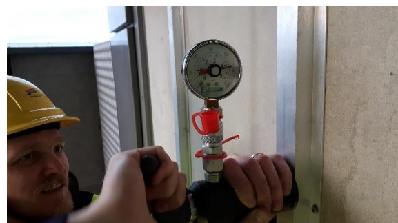
Mynd 34: Framkvæmt var próf á skrúfum í nýjum götum í miðjuleiðurum. Skrúfur voru vel fastar ar við prófið og hafa gott togþol m.v. hönnunarálág.
