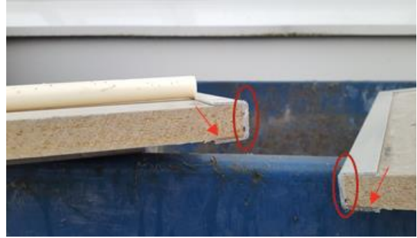
Mynd 8 Búið að saga plötu til helminga sem sýnir skurð við U-skúffu. Mynd sýnir að kitti er ekki fullþétt og eru ummerki um að loftbólur hafi verið í kittun (rauður hringur). Einnig má sjá ummerki um raka/bleytu við ytri brún Viroc (rauð ör).
