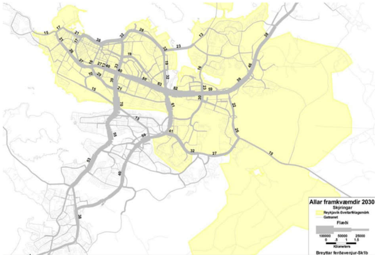
Mynd 15: Umferðarspá fyrir árið 2030, m.v. breyttar ferðavenjur og nýframkvæmdir
