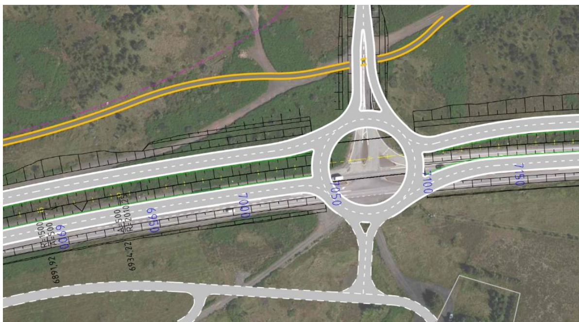
MYND 3.22 Tvöfalt hringtorg á vegamótum við Hafravatnsveg, sem eru hluti af 2. áfanga framkvæmdarinnar.
