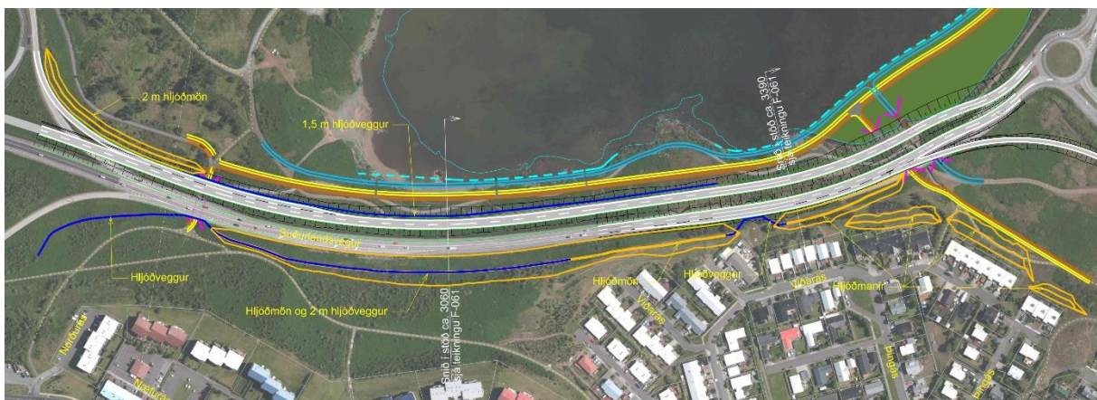
MYND 76 Fyrirhugaðar hljóðvarnir við Selás og Rauðavatn. Útlínur hljóðmana eru gular og hljóðveggir eru dökkbláir.
