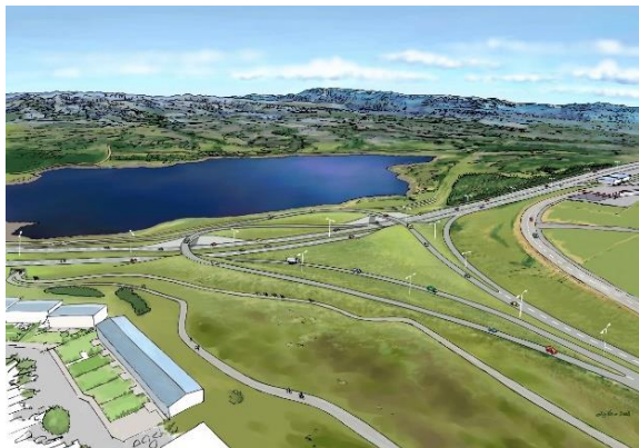
MYND 48 Mislæg vegamót við Breiðholtsbraut, lausn 2, peruvegamót (mynd Sigurður Valur). Stígar eru ekki sýndir í samræmi við frumdrögin.
