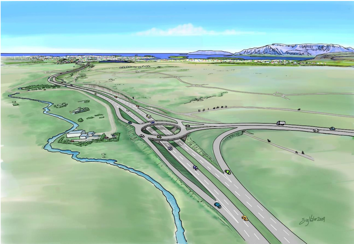
MYND 3.11 Mislæg vegamót við Hafravatnsveg (mynd Sigurður Valur).
