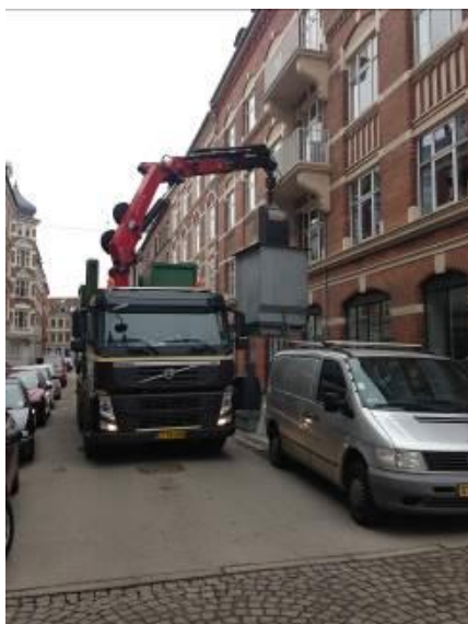
Mynd 35 – sýnir dæmi um sorphirðubíl með gálga sem tæmir djúpgám og dæmi um djúpgámastöð.
