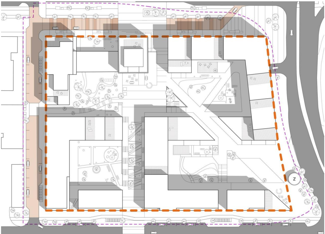
Mynd 27 – Skýringarmynd sem sýnir ný lóðarmörk lóðarinnar Suðurlandsbraut 34 – Ármúli 31 (appelsínugul brotalína). Eldri lóðarmörk eru sýnd með fjólubláari brotalínu. Stærð hinnar nýju lóðar er áætluð 18.749 fm. Að auki verða til svokallaðar fylgiloðir utan um djúpgámastöðvar sem lenda utan lóðar í göturými nærri Orkureit auk þess sem útbúin verður ný lóð undir dreifistöð Veitna (merkt með Z). Endanleg stærð og staðsetning þeirra er háð endanlegri staðsetningu og stærð djúpgámastöðvanna, sbr. umfjöllun í kafla 1.16 og 2.14.
