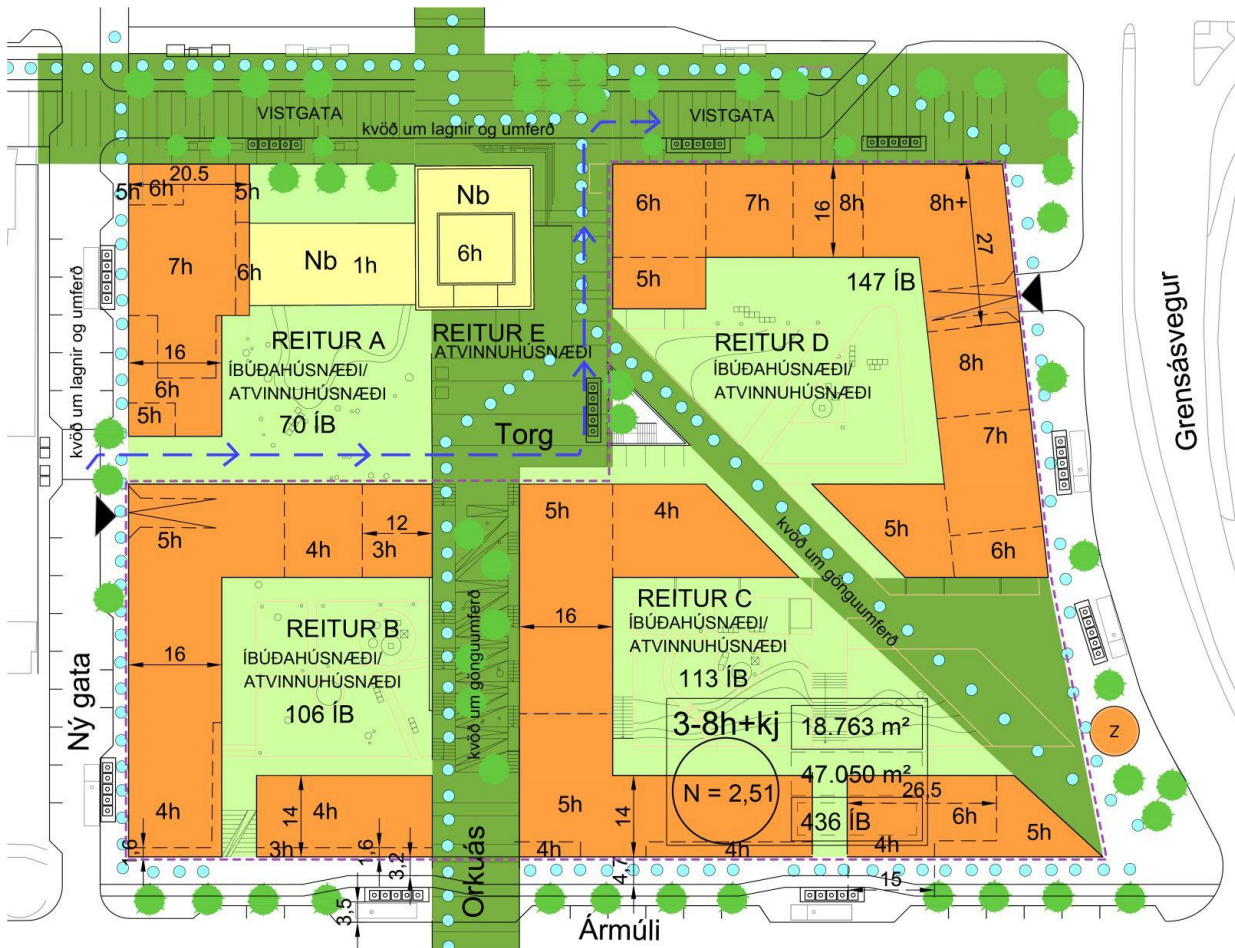
Mynd 14 – Hluti af skipulagsupprætti. Byggingarreitir samkvæmt skipulaginu merktir sem reitir A til E. Bílgeymsla verður undir þremur reitum, B, C og D og er hún afmörkuð með fjólublárrí stríkalínu.
