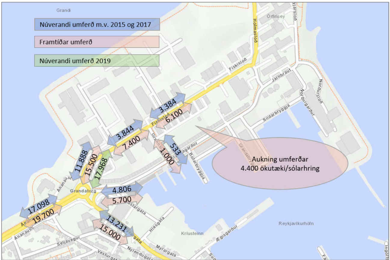
MYND 10 Væntanleg dreifing umferðar um skipulagssvæðið m.v. sviðsmynd 2. Umferð er áætluð m.v. fullbyggðan Línbergsreit, ökutæki/sólarhring.
