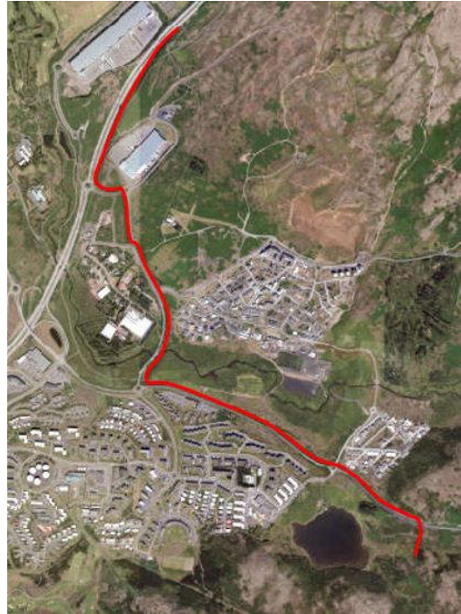
Mynd 6: Tillaga 2 - Strenglögn meðfram Vesturlandsvegi, strengurinn liggur meðfram Úlfarsfellsvegi og Lambhagavegi, og lagður í göngustíginn þegar þess þarf.
