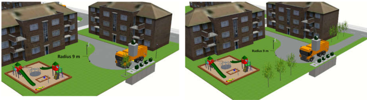
MYND 13 Lágmarksstærð snúningssvæðis fyrir hirðubíl.
