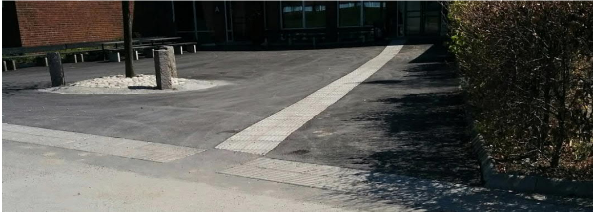
Mynd 4-9 Á stórum opnum svæðum er mikilvægt að geta leiðbeint blindum og sjónskertum um hvar leiðin liggir. Á þessari mynd leiða sértækar leiðarlínur blinda og sjónskerta að aðalinngangi skóla (Mynd: Berglind Hallgrímsdóttir).
