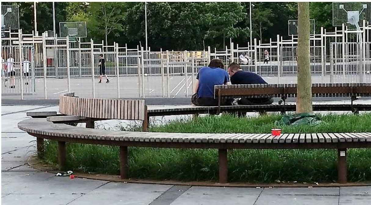
Mynd 4-5 Dæmi um einfalda hönnun á bekk sem þó uppfyllir skilyrði hvað varðar arm- og bakstuðning á hluta bekkjar (Mynd Áslaug Katrín Aðalsteinsdóttir).
