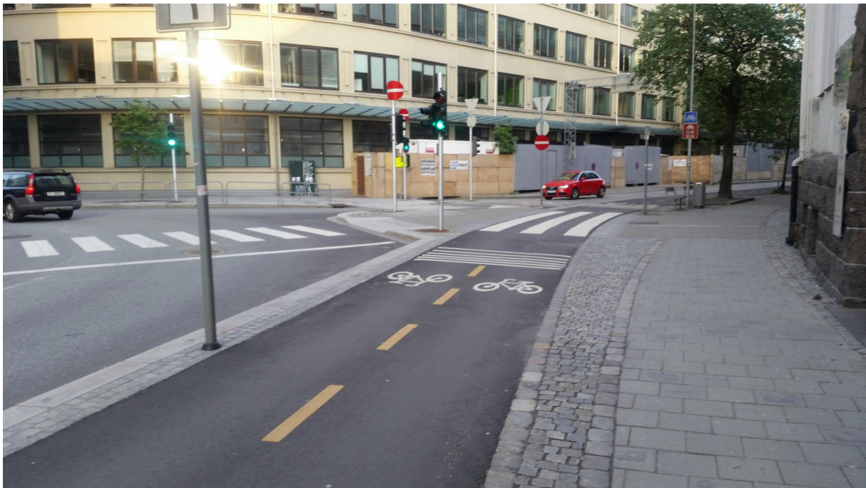
Mynd 4-7 Á myndinni má sjá skýr skil á milli vegfarendahópa, sjálfgefna leiðarlínur eru beggja megin við gangstéttina og skýr kantur að hjólastíg (Mynd: Áslaug Katrín Aðalsteinsdóttir)
