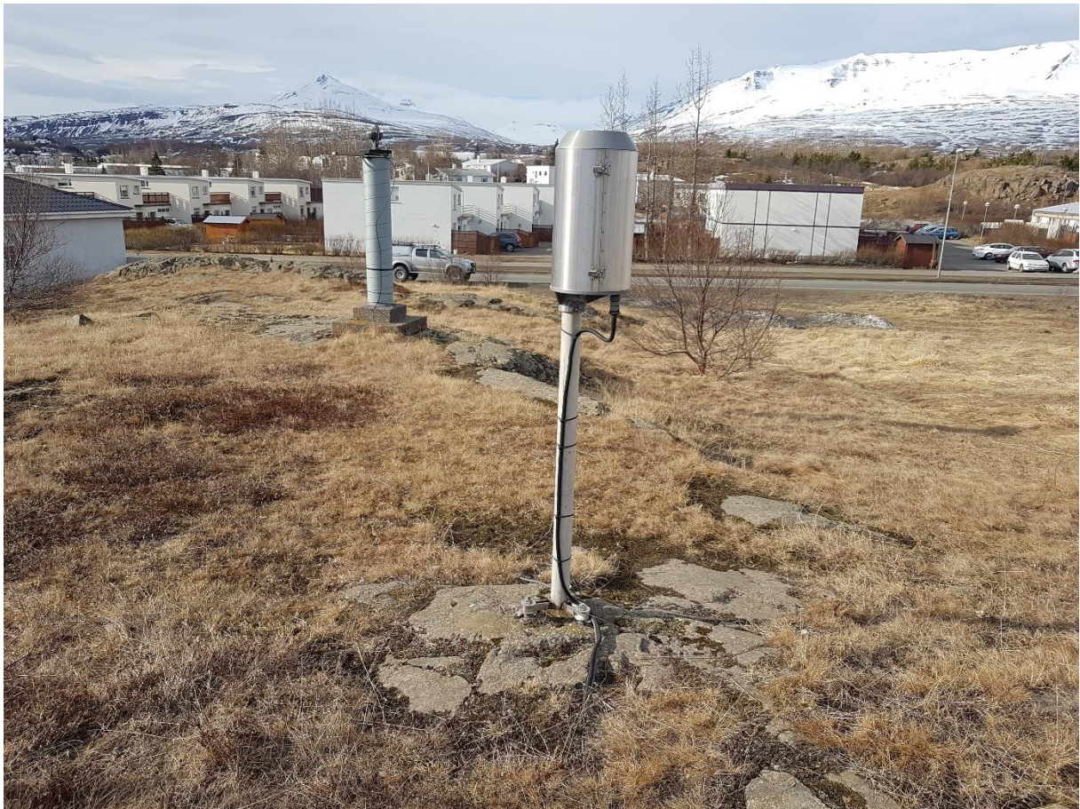
4. mynd. Úrkomumælir svipaður þeim sem settur yrði upp í Hljómskálagarðinum
