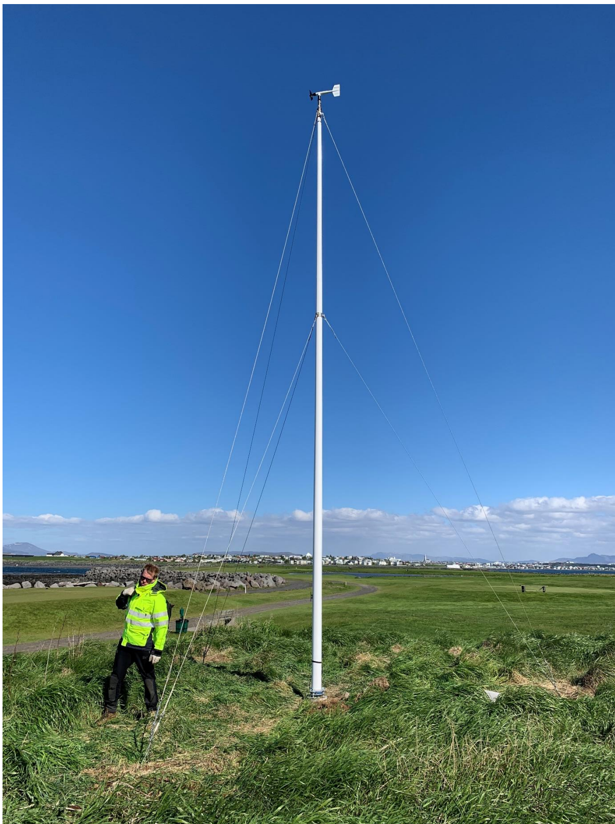
6. mynd. 10 metra fánastöng með vindmæli. Stöngin í Hljómskálagarði myndi ekki hafa vírastög eins og sjást á mynd.
