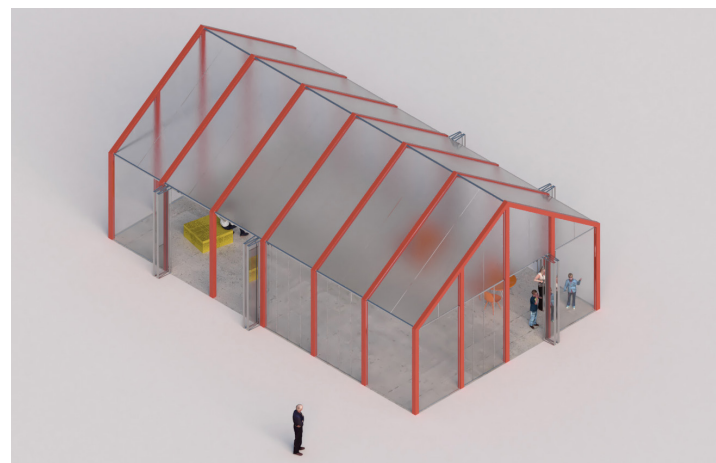
DÆMI 3: Gler hliðar + pólýkarbónat þak
