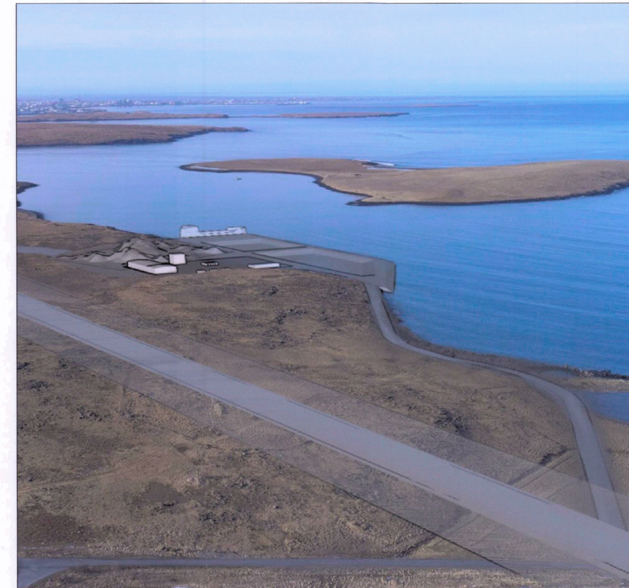
Skýringarmynd: Möguleg ásynd á skipulagssvæðið. Landfylling og dæmi um hvernig byggingar, setlón, efnishaugar og tæki geta verið staðsett á landfyllingu. Skip er þar sem viðlegukantur er áformaður. Sýnd er möguleg lega bráðabirgðavegar að norðan, með tjörninni, lega Sundabrautar skv. aðalskipulagi og möguleg tenging við skipulagssvæðið frá Sundabraut að sunnanverðu.
