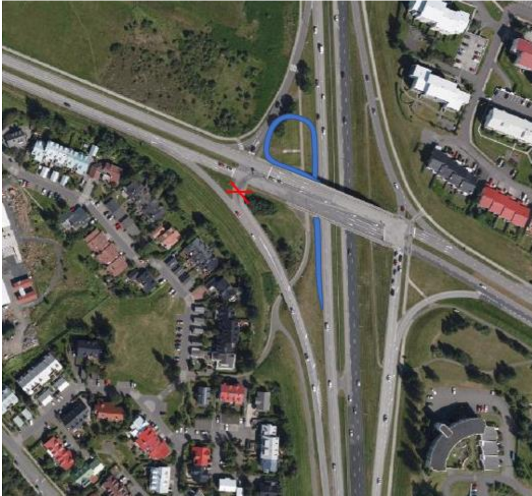
Mynd 3-3 Framkvæmdalausn með slaufu undir Bústaðabrú
