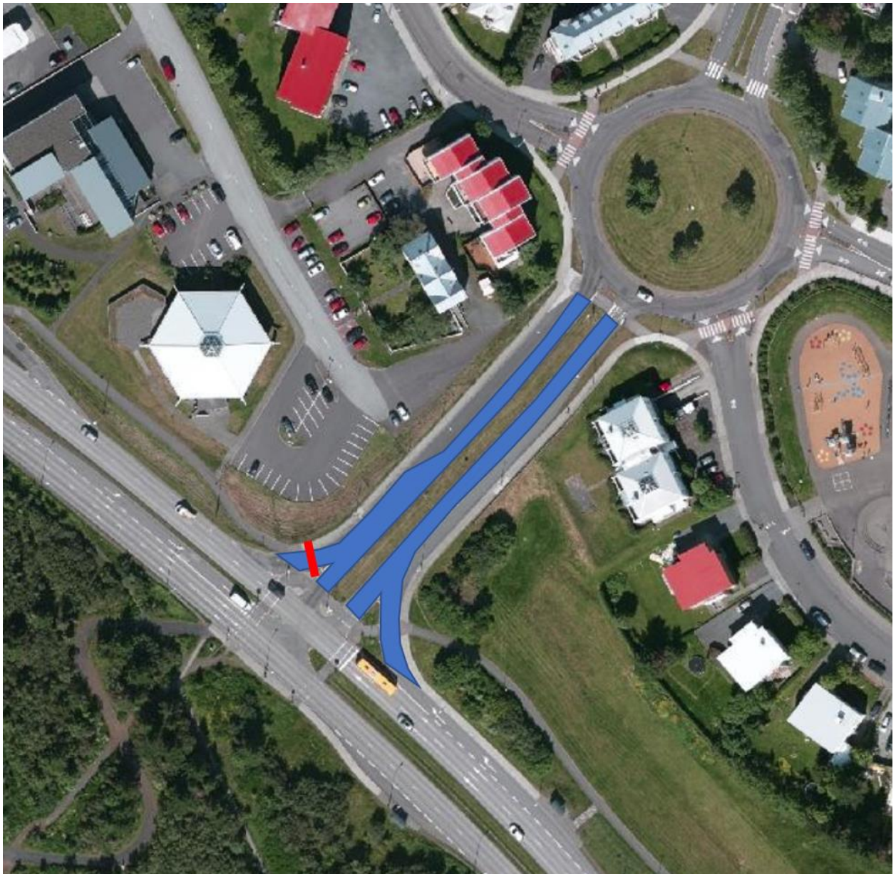
Mynd 7-1 Gatnamót Bústaðavegs og Litluhlíðar, 1+1 lausn með 35 m langri hægri beygju frárein og ljósastýringu.
