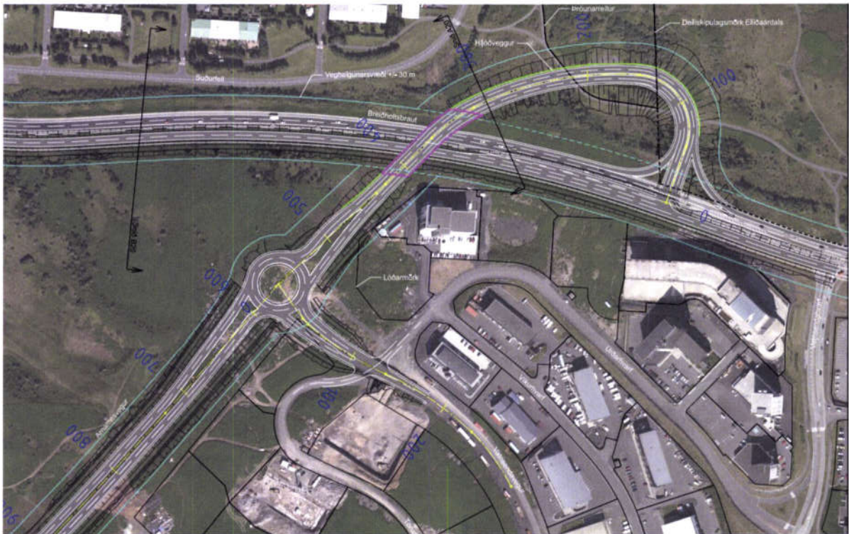
Mynd 6.1 Útfærsla vegamóta Arnarnesvegur og Breiðholtsbrautar miðað við framlagða tillögu (drög að tillögu Efla og Vegagerðin 2020).
