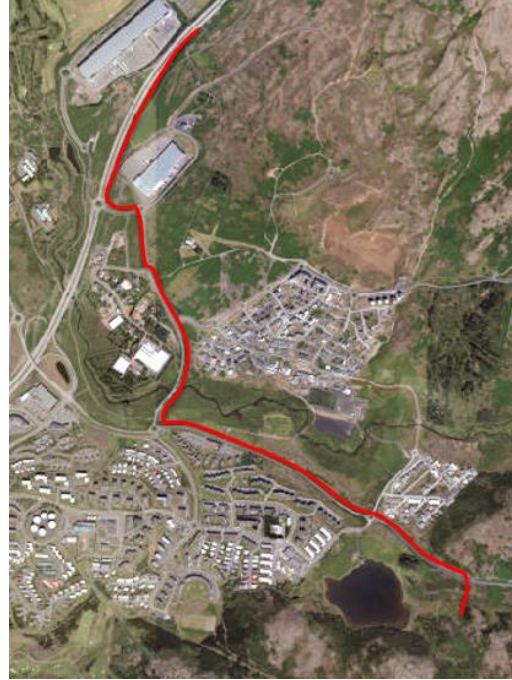
Mynd 6: Tillaga 2 - Strenglagn meðfram Vesturlandsvegi, strengurinn liggur meðfram Úlfarsfellsvegi og Lambhagavegi, og lagður í göngustíginn þegar þess þarf.
