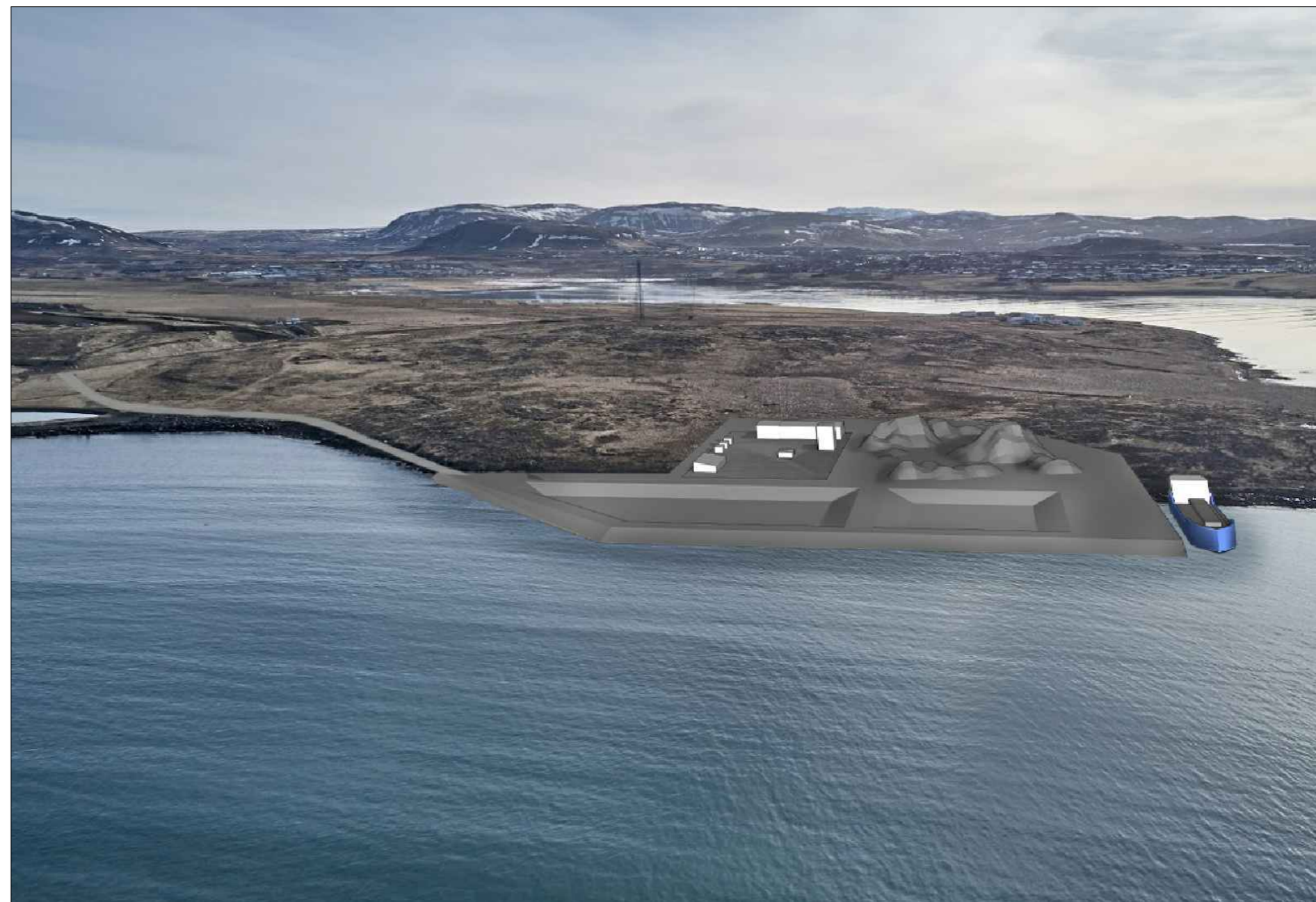
Skýringarmynd: Möguleg ásjón á skipulagssvæðið. Landfylling og dæmi um hvernig byggingar, setlón, efnishaugar og tæki geta verið staðsett á landfyllingu. Skip er þar sem viðlegukantur er áætlaður.
