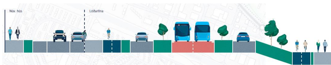
Suðurlandsbraut við Laugardal. Borgarlínan í sérrými, göngu- og hjólastígar. Akreinar fyrir bílaumferð. Hliðargata að lóðum sunnan Suðurlandsbrautar.
