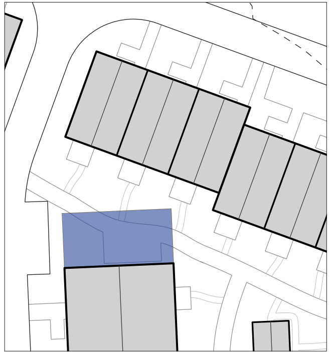
a) Gavfl til útveggjar - 1:1.5 (fjarlægð/hæð byggingar)
