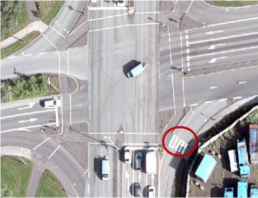
MYND 4 Hægribeygju framhjáhlauþ við Kleppsmýrarveg. Æskilegt væri að fjarlægja sebrabraut (rauður hringur á mynd).
