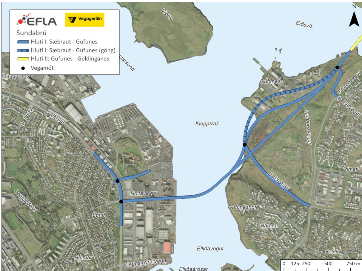
MYND 3.1 Sundabrá, hluti I, með tengingum til suðurs og vesturs við Sæbraut og í Gufunesi. Á myndinni eru þrjú valkosti fyrir legu Sundabrautar í Gufunesi sýndir, þ.e. yfir sorphaugana á um 800 m kafla (austasta línan), vestan við sorphaugana (miðlína) eða jarðgöng undir sorphaugana (brotin lína vestast). Kort: EFLA, 2023
