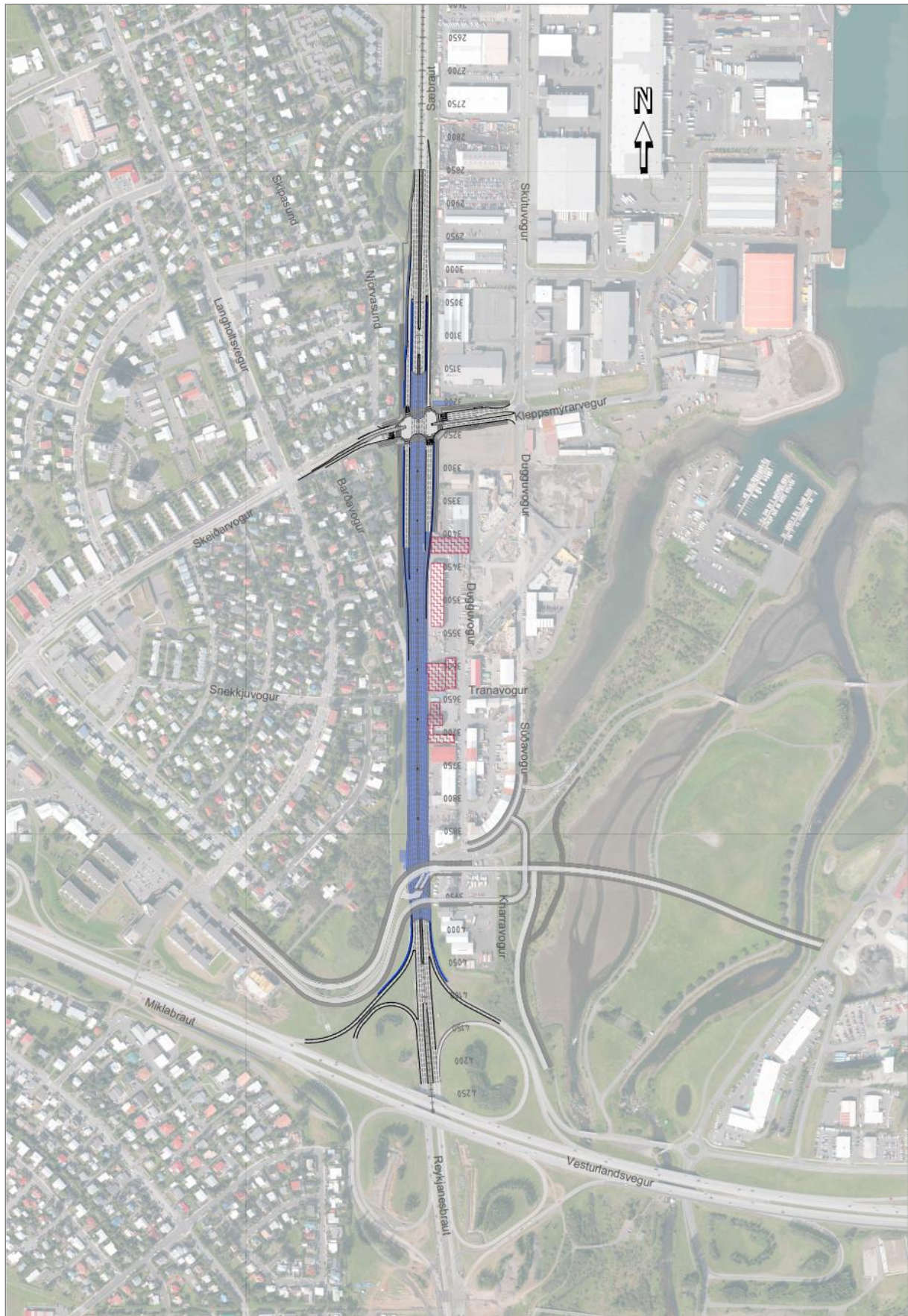
Mynd 4.1 Yfirlitsmynd sem sýnir fyrirhugaðan vegstokk og aðliggjandi gatnatengingar auk legu Borgarlínu og tengingar Súðavogs og Suðurlandsbrautar.
