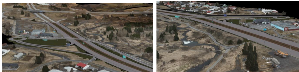
MYND 4.3 Tölvugerðar líkanmyndir af fyrirhuguðum gatnamótum Reykjanesbrautar og Bústaðavegar fyrir lausn með vinstri beygju á brú (EFLA, 2022).
