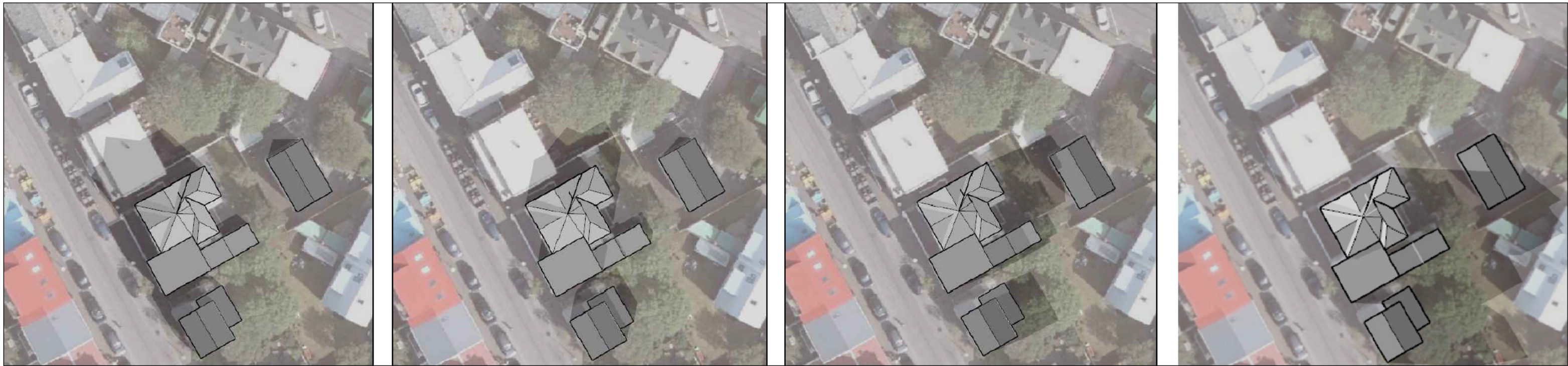
Skuggavarp fyrir breytingu 21.júní kl.10:00 Skuggavarp fyrir breytingu 21.júní kl.13:00 Skuggavarp fyrir breytingu 21.júní kl.16:00 Skuggavarp fyrir breytingu 21.júní kl.18:00
