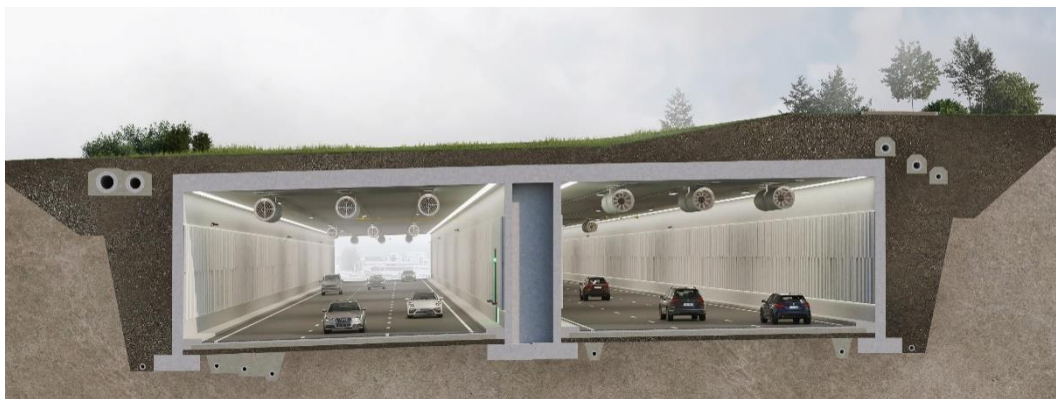
Mynd 15. Skýringarmynd af þversniði stokksins.
