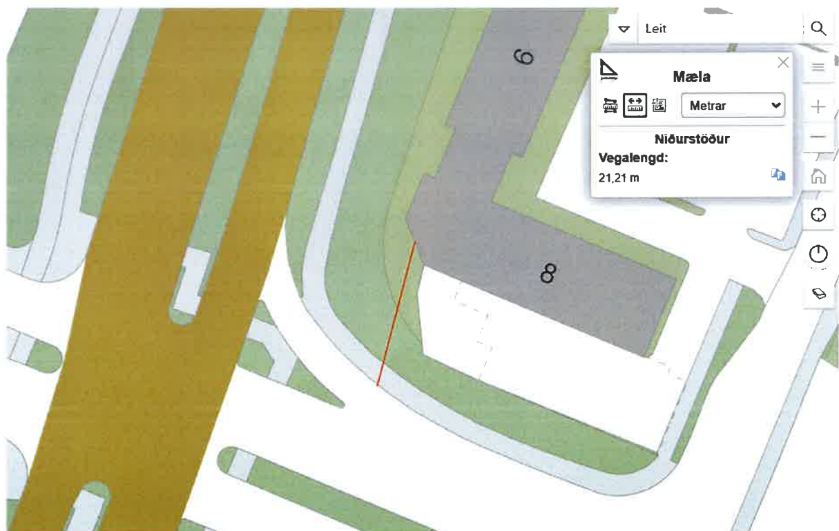
Mynd C. Fjarlægð frá skilti að vegbrún götu (Háaleitisbraut), 21,21 metrar.
