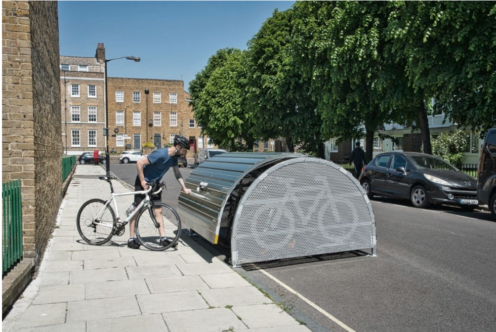
Mynd 4.4 Hjólabúr eru einföld lausn til að breyta bílastæði í yfirbyggð hjólastæði.
