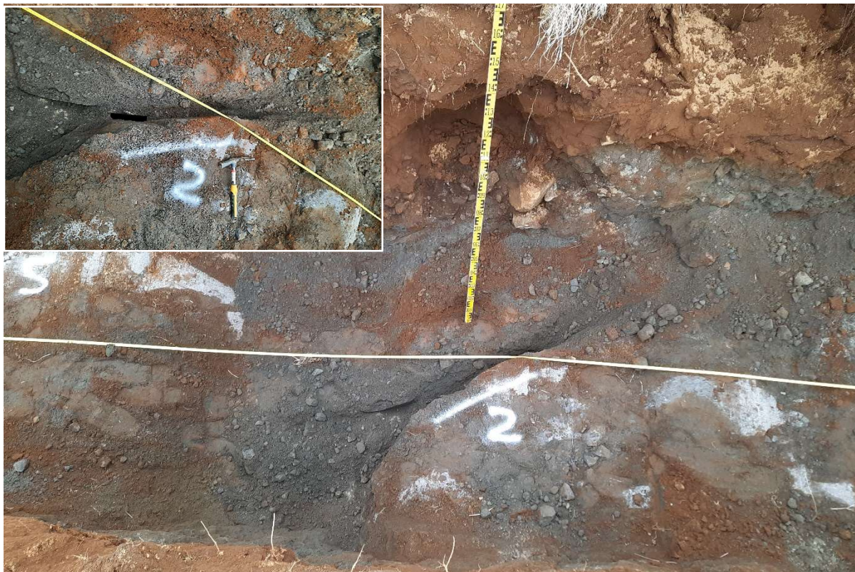
Mynd 32. Skurður 4b. Horft yfir sprungu í stöð 3 frá syðri bakka skurðar. Á innfeldri mynd uppi í vinstra horninu er nærmynd af sprungunni.
