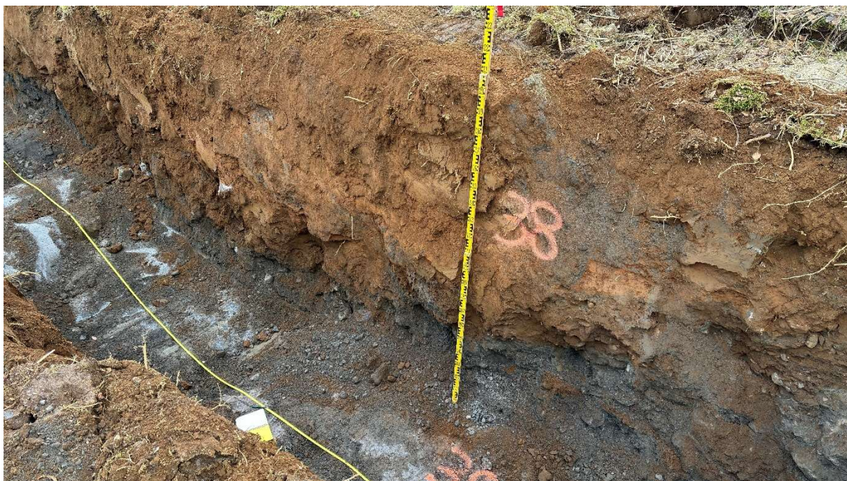
Mynd 11: Skurður 2. Á stöðvarbili 38-43 hvarf nánast jökulruðningurinn og moldarjarðvegurinn var þykkari. Á yfirborði var lægð á þessu svæði, líklega hefur vatn runnið þarna og rofið jökulruðninginn sem síðar hefur fyllst af moldarjarðvegi.
