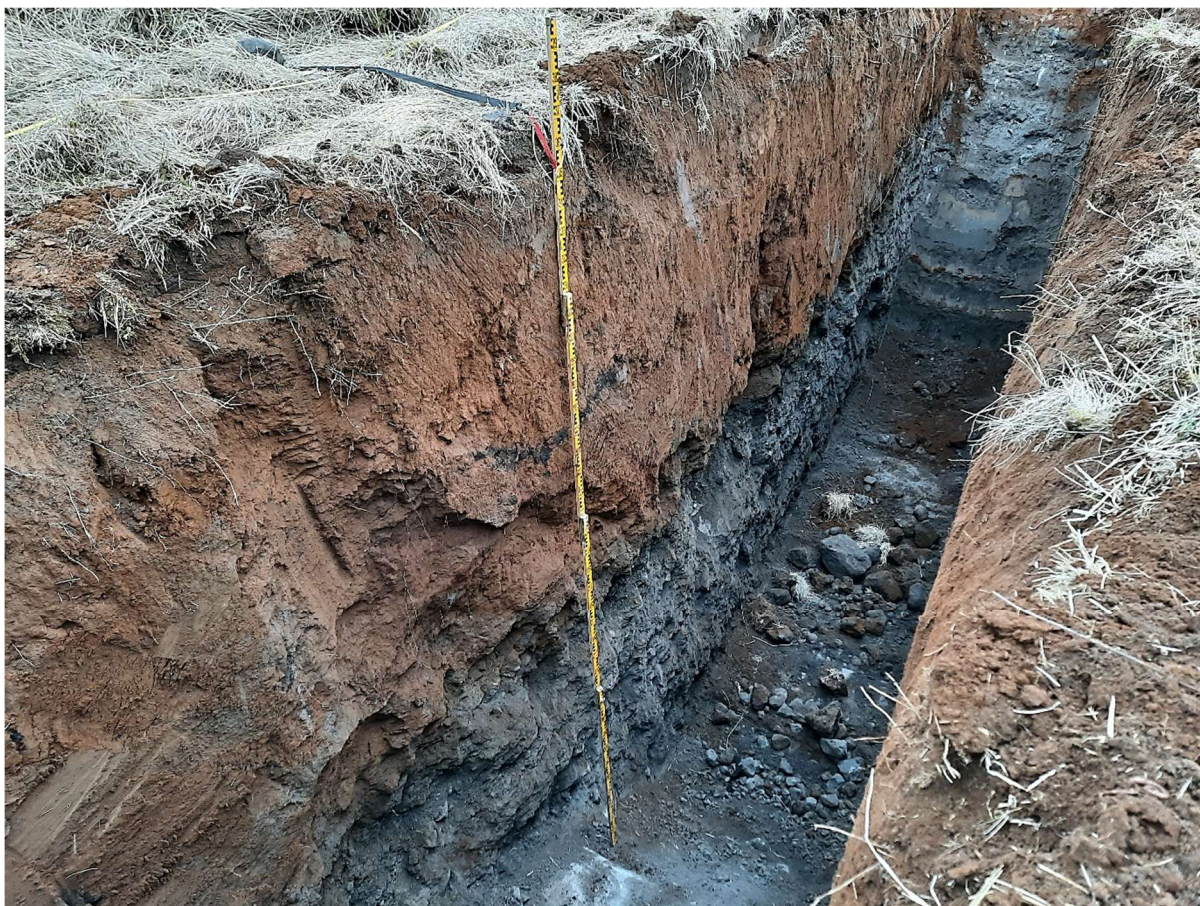
Mynd 44. Skurður 7. Vegna dýpis náðist ekki að grafa örugglega niður á klöpp, en skurðbotninn nokkuð fastur og torgræfur.
