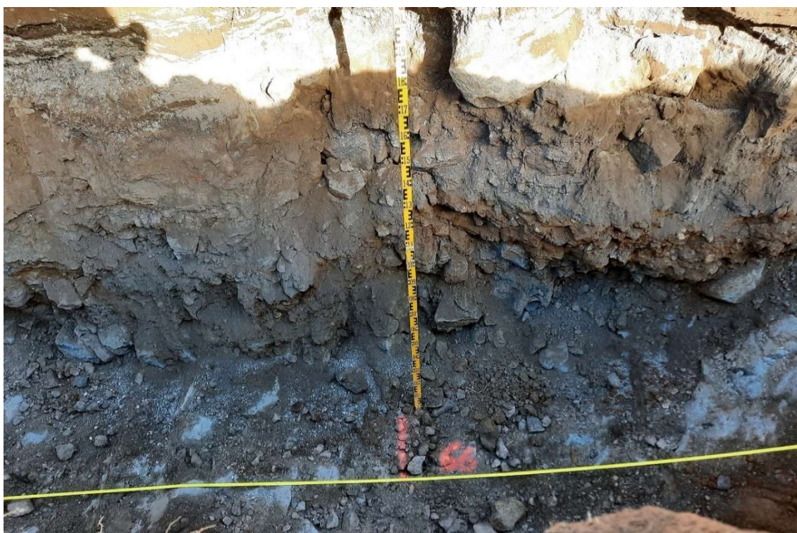
Mynd 4: Skurður 1. Óljós/óvirk sprunga í stöð 66, horft á hægri vegg. Það mátti greina jökulruðningsset sem hafði farið ofan í sprunguna og basalt var losaralegt í veggjum í kringum hana.
