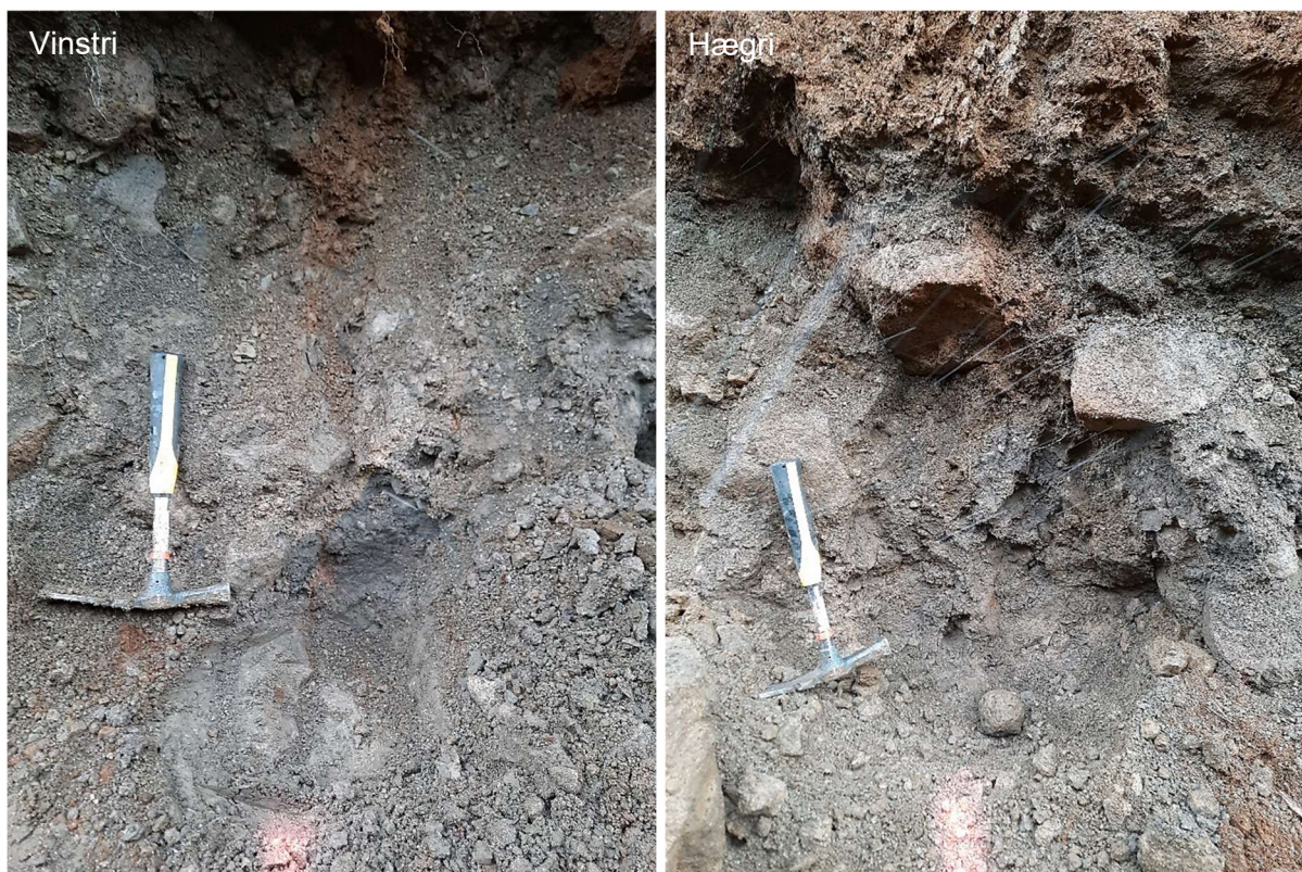
Mynd 15. Skurður 3, virk sprunga í stöð 54. Greinilegir moldarfleygar niður í jökulruðninginn í báðum veggjum.
