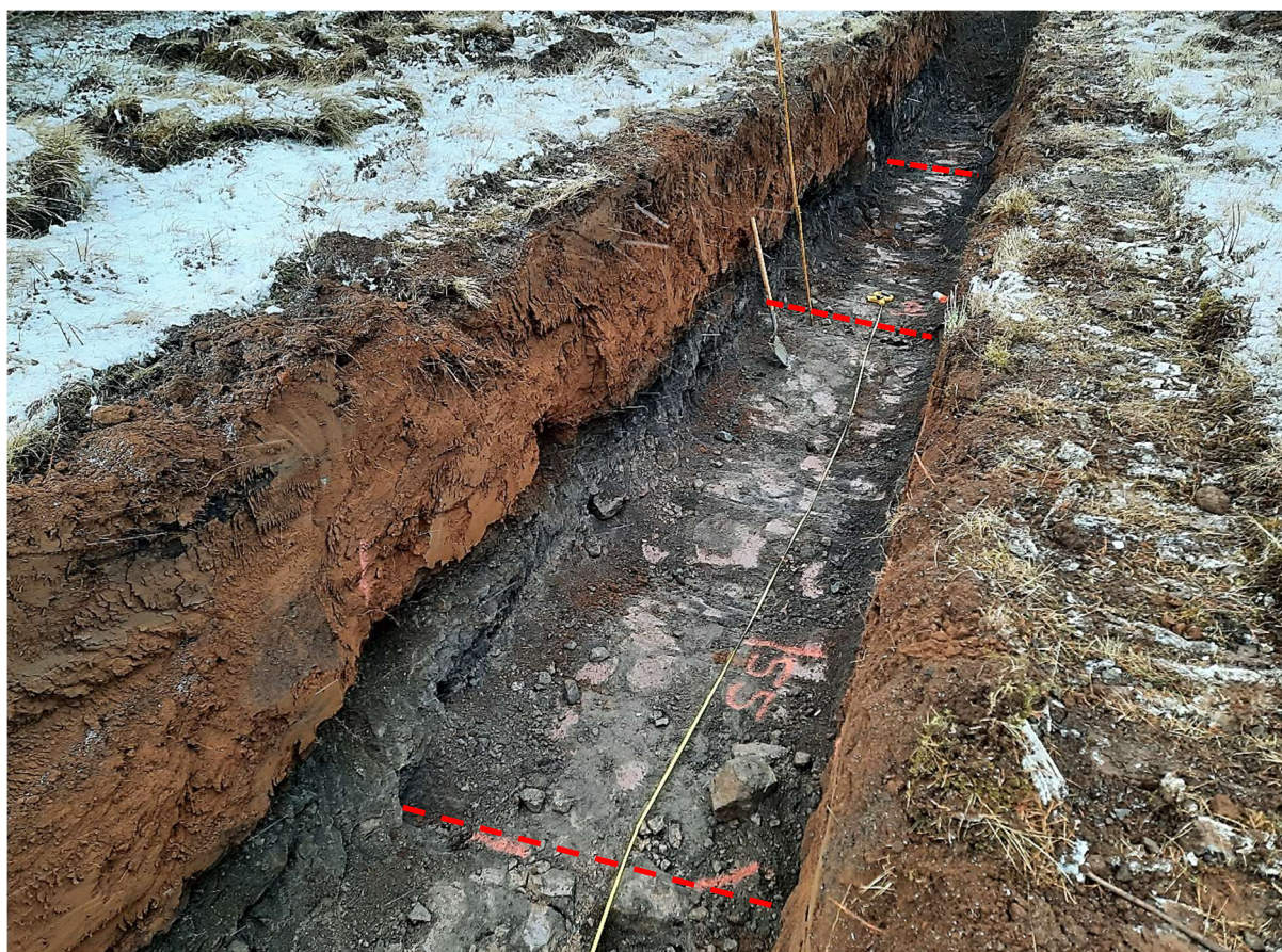
Mynd 5. Horft fram eftir skurði 3 og yfir sprungurnar í stöð 54, 60 og 66 (rauðar brotalínur).
