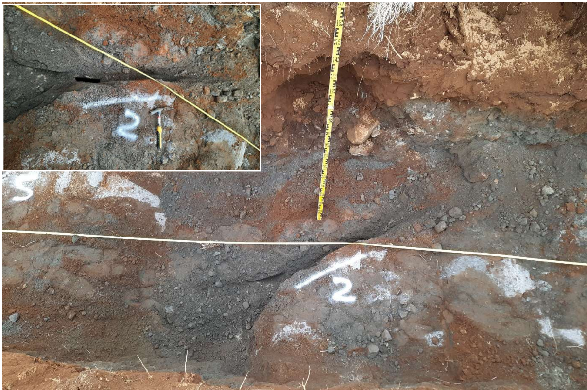
Mynd 32. Skurður 4b. Horft yfir sprungu í stöð 3 frá syðri bakka skurðar. Á innfældri mynd uppi í vinstra horninu er nærmynd af sprungunni.
