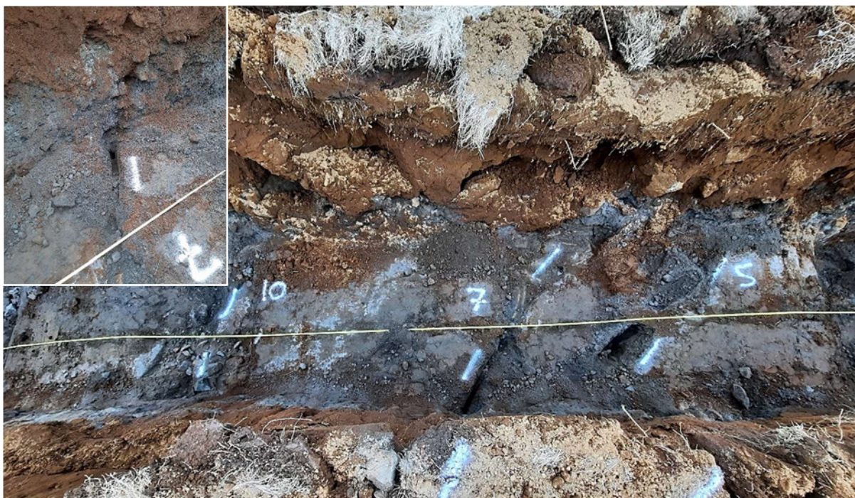
Mynd 33. Skurður 4b. Horft yfir sprungur í stöð 5, 7 og 10 frá syðri bakka skurðar. Virkar sprungur í stöð 5 og 7 voru gapandi á köflum, en sprunga í stöð 10 var það ekki. Á innfelldri mynd uppi í vinstra horninu er nærmynd af sprungunni í stöð 7 (vinstri veggur). Greinilegur moldarfleygur niður í jökulruðning.
