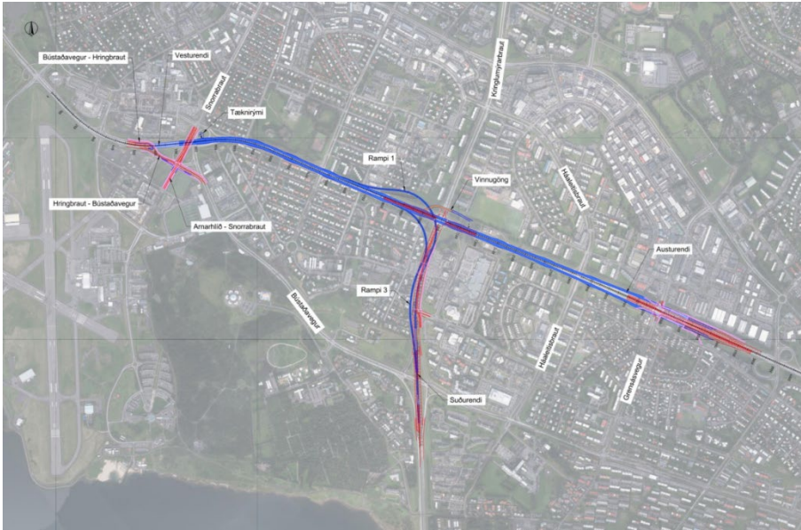
Mynd 7 Útfærsla á Miklubrautargöngum frá Skeifu í austri að Landspítala í vestri með tengigöngum á Kringlumýrabraut sunnan Listabrautar.
