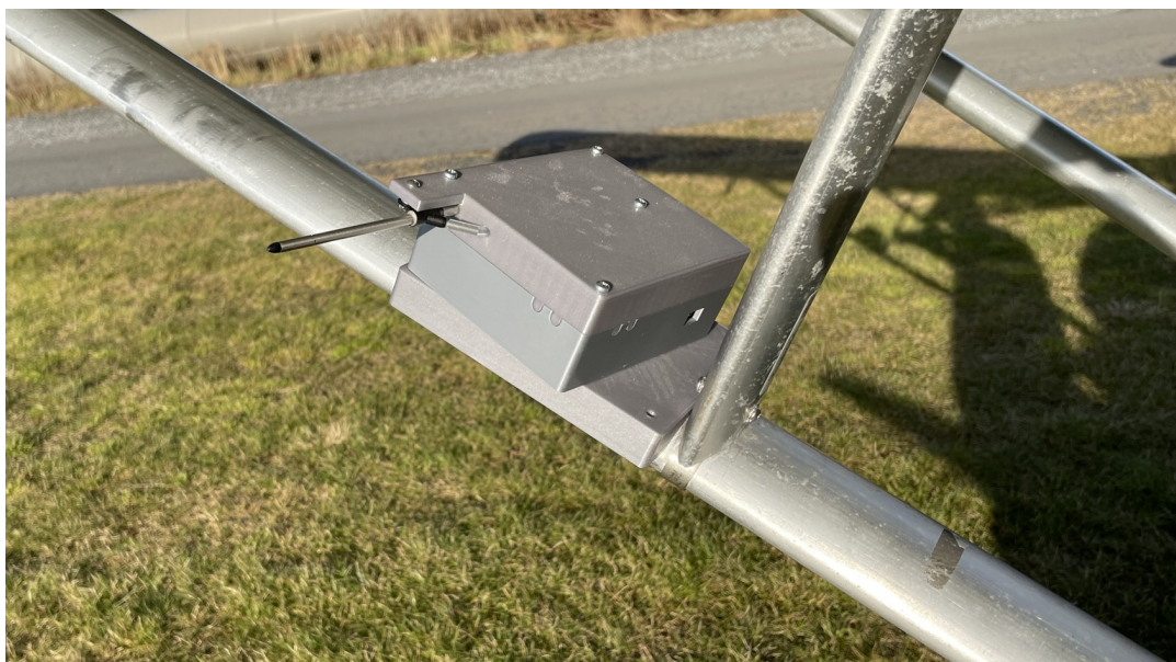
Mynd 1: Hér má sjá tölvuna á vængstífunni. Botnstykkið sem skrúfast við kassann sem inniheldur tölvuna hefur vængstífuprófilinn svo hún situr nokkuð stöðug, sem leiðrétti snúning svo hún snýr beint upp í vindinn. Veltan er svo leiðrétt með hugbúnaði. Kassinn er svo límduð niður fyrir flugtak.
