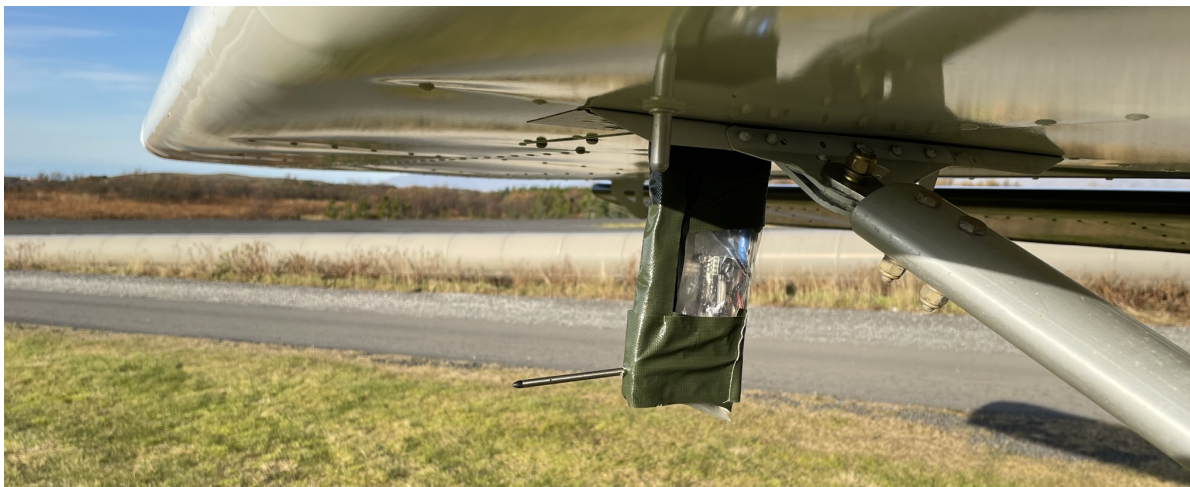
Mynd 2: Á þessari mynd sést pitot-rörið sem er tengt við tölvuna inn í stjórnklefa. Móttökutækið sem sendir gögnin til Pixhawk 4 er klætt með plasti til að verja fyrir veðri og vindum. Límbandið náði ekki yfir tölvuna svo hægt væri að sjá ljós sem er á tækinu.
