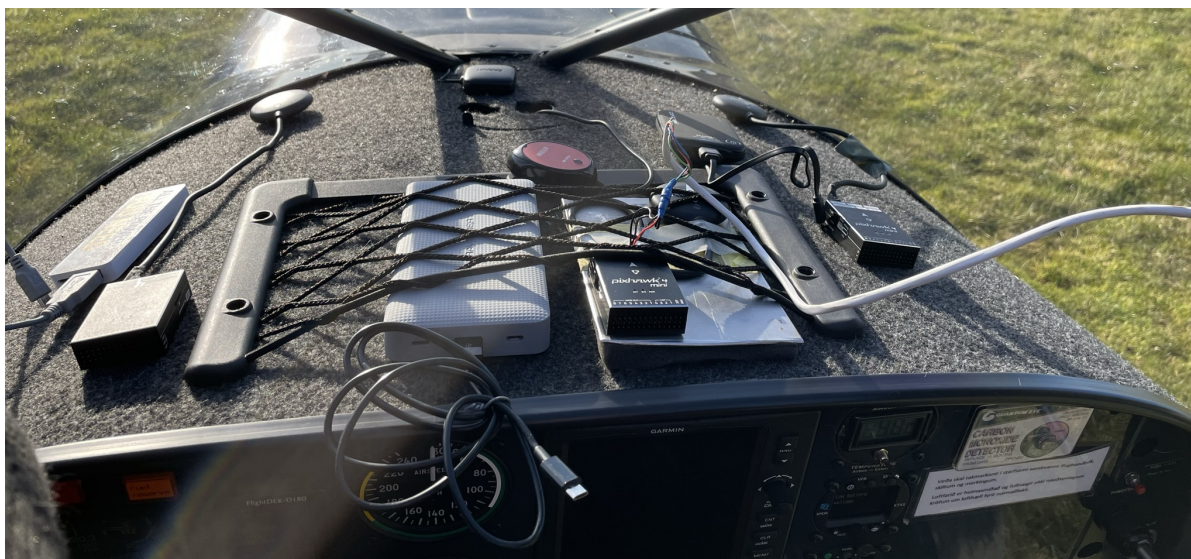
Mynd 1: Hér má sjá þrjár Pixhawk tölvur. Tölva 1 er fyrir miðju á álplötu. Í hana er hvít snúra sem er tengingin við Pitot-rörið út á vængnum. Stór rafhlöðupakki er við hliðina á henni sem annars væri tengt við hana í flugi. Tölvunni er haldið niðri með teygjunni sem sést á myndinni. Á mælaborðinu sjáftu er dúkur og á hinar tvær tölvurnar var settur franskur rennilás og var það notað til þess að halda þeim niðri ásamt rafhlöðupökkunum tengt við þær.
