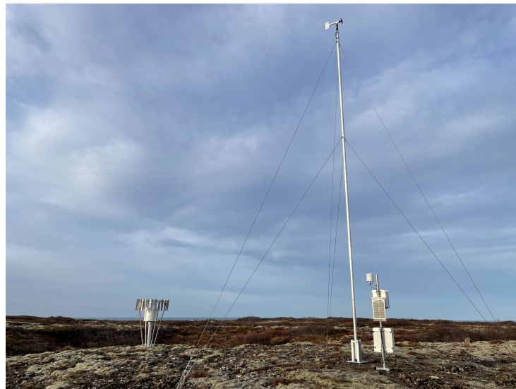
Mynd 2. Hvassahraun á Hólsbrunahæð (hvass): Ljósmynd af veðurstöðinni. Vindmælingamastur, hita- og rakamælir í forgrunni og úrkomumælir í bakgrunni. Ljósmynd: Ágúst Þór Gunnlaugsson, 3. febrúar 2021.
