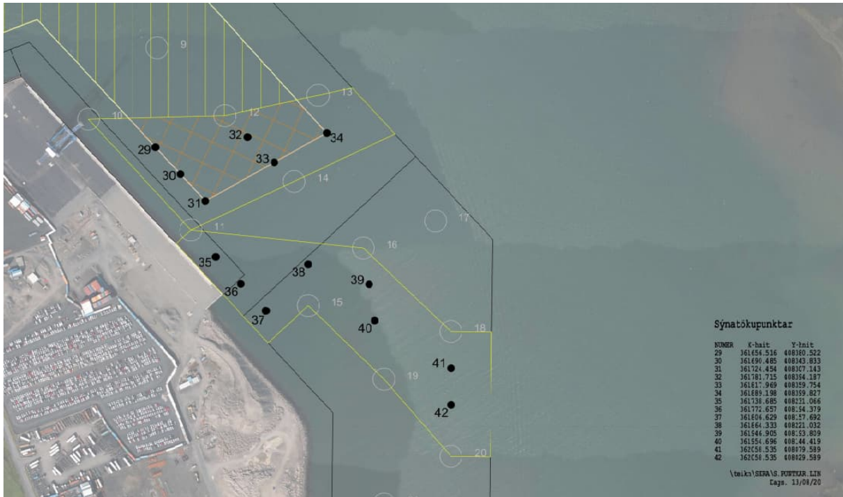
Mynd 1-3 Sýnatökustaðir árið 2020, 14 borholur nr. 29-42. Borholur 29-34 voru innan fyrirhugaðs dýpkunaráfanga utan Sundabakka. (Loftmynd frá Loftmyndum ehf.)
