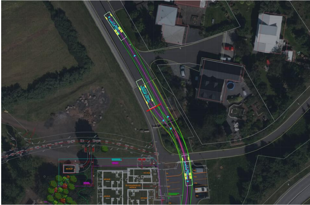
Mynd 6 Myndin sýnir 12 m strætisvagna aka úr sitthvorri áttinni. Hér sést hvar vagn sem kemur eftir Stjörnugróf þarf að stoppa (við rauðu línuna) til að hleypa vagni úr Fossvogsbrún í gegn.
