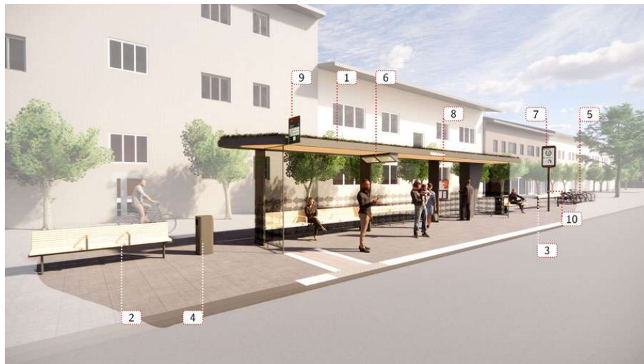
Mynd 19. Mynd sem sýnir aðlaðandi þætti borgarlínustöðvar. 1) skýli, 2) hliðarbekkur, 3) standbekkir fyrir standandi farþega, 4) ruslakarfa, 5) hjólastandur, 6-7) rauntímaupplýsingar, 8) upplýsingaskilti, 9) stöðvarskilti, 10) hátalari
