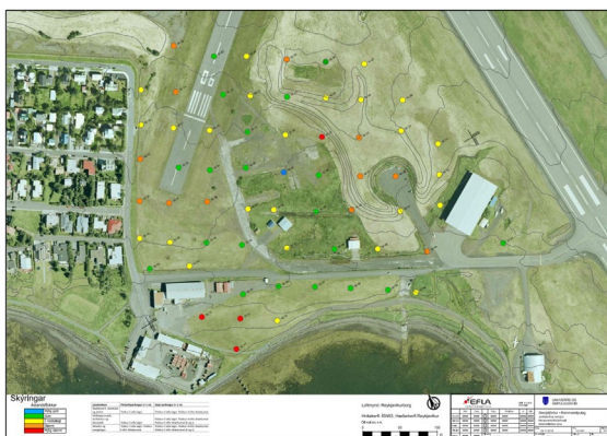
Mynd 9. Skjástot úr skýrslu sem sýnir ástand jarðvegs á ákveðnum mæliholum
