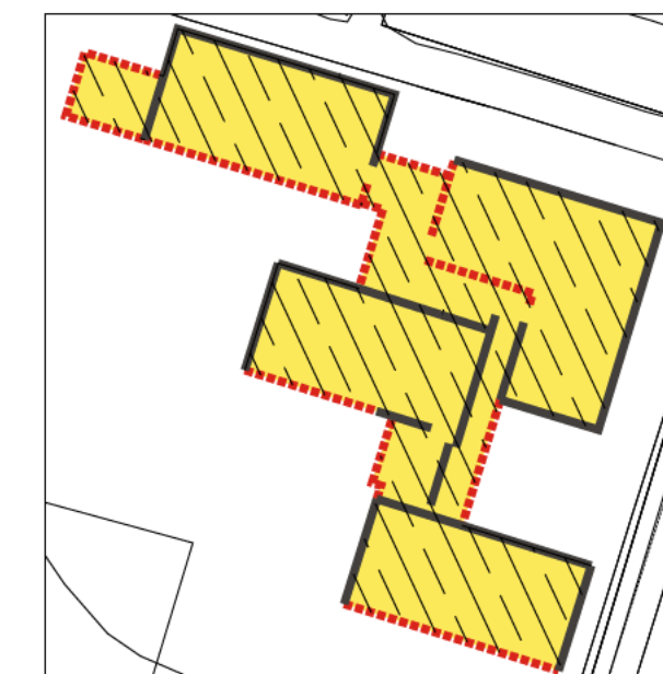
Skýringarmynd fyrir niðurrif á veggjum núverandi leikskólabyggingar. Heilar svartar línur sýna veggir sem eru áfram, rauðar brotalínur sýna veggir sem verða rifnir niður. Þakið verður endurnýjað í heild sinni. Mkv. 1:500.
