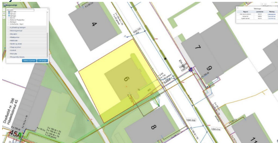
Mynd 5.1 er skjámynd af heimasíðu borgarvefsjá.is Á myndum má sjá að rafmagnslagnir liggja í gangstétt fyrir framan húsið.
