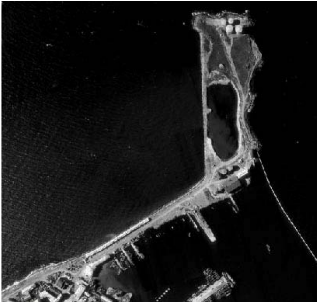
Á þessari loftmynd frá 1954 má sjá lónið sem búið var til og fyllt upp í vestan Örfiriseyjar. 75
