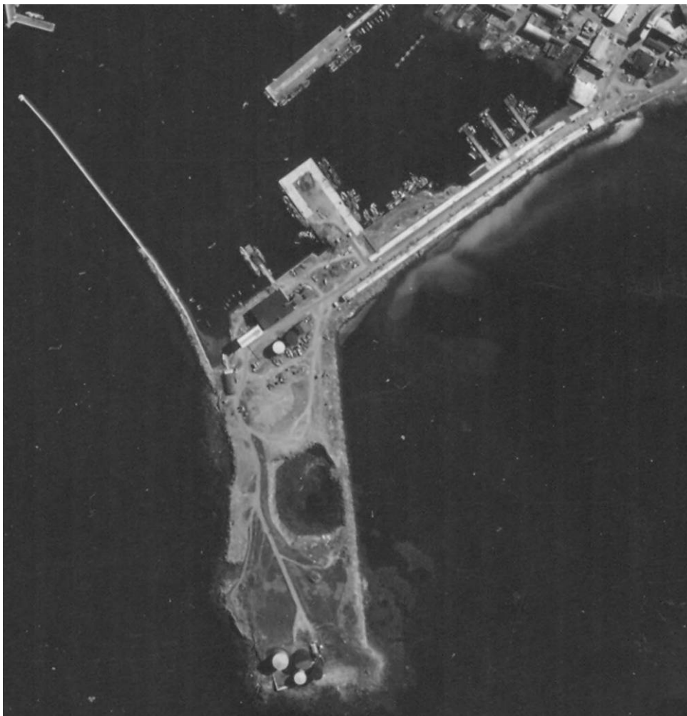
Örfirisey og Grandagarður á loftmynd frá um 1960. Hér sést að uppfyllingin suðvestur úr eyjunni er langt komin og að fleiri hús eru risin við verbúðabryggjurnar við Grandagarð. Einnig er búið að byggja seinni áfanga verbúðalengjunnar norður eftir Grandagarði. 81
