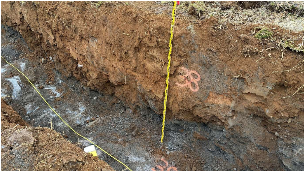
Mynd 11: Skurður 2. Á stöðvarbili 38-43 hvarf nánast jökulruðningurinn og moldarjarðvegurinn var þykkari. Á yfirborði var lægð á þessu svæði, líklega hefur vatn runnið þarna og rofið jökulruðninginn sem síðar hefur fyllst af moldarjarðvegi.
