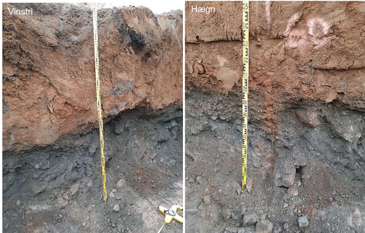
Mynd 17. Skurður 3, virk sprunga í stöð 60. Greinilegur moldarfleygur niður í jökulruðninginn í hægri vegg.
