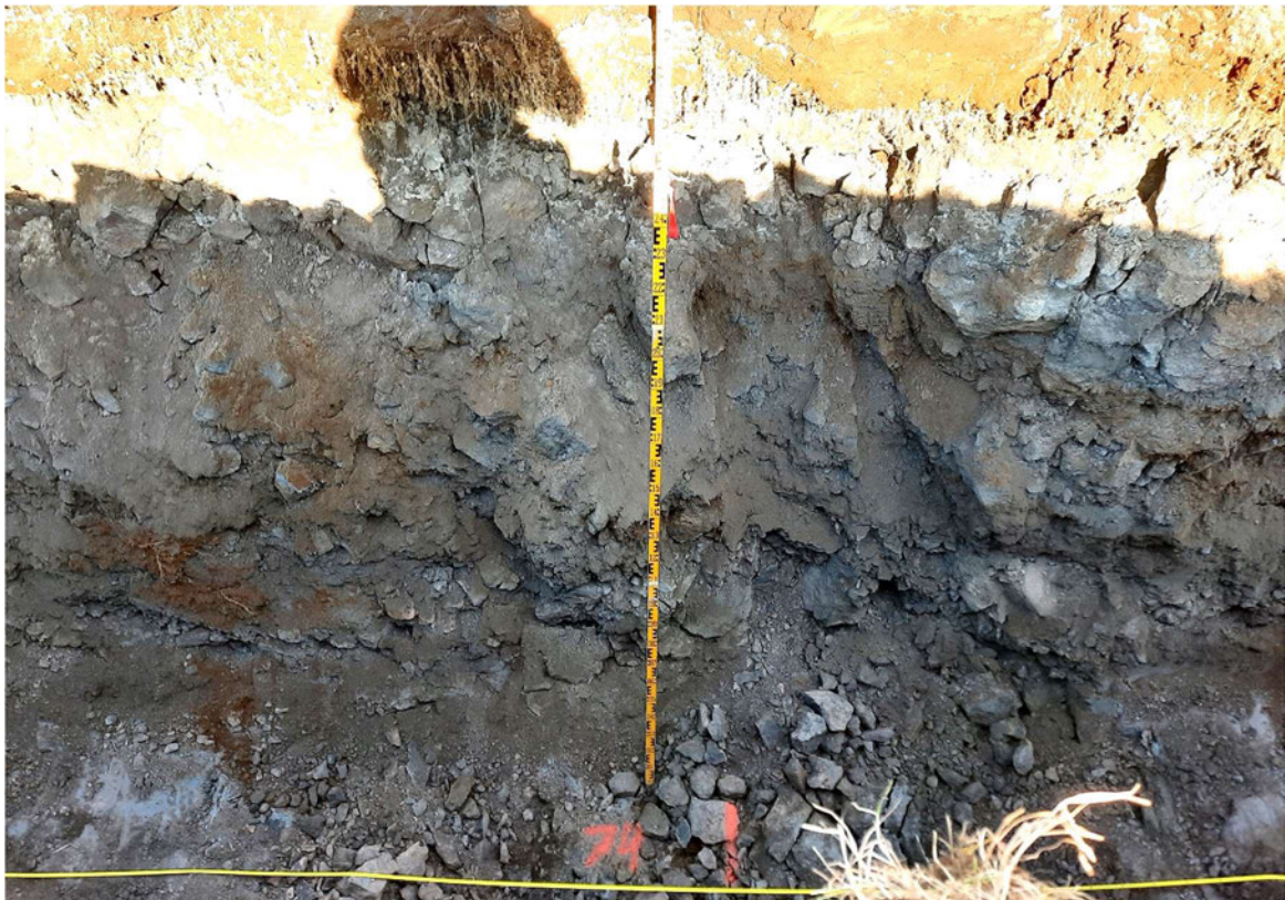
Mynd 6: Skurður 1. Óljós/óvirk sprunga í stöð 74, horft á hægri vegg. Ummerki um hreyfingar í jökulruðningi. Smá yfirbrot í botni skurðar.
