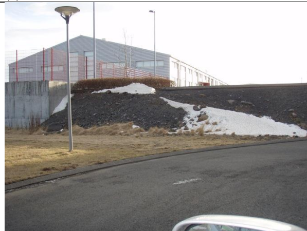
Mynd nr. 4. Aðeins kantsteinn tekur á móti bílum við enda á bílastæðum vestast á bílaplani sunnan við Norðurhús. Það tekur við há brekka ef bílar fara yfir kantsteininn. Lagt er til að gerður verði veggur við enda bílaplans . (2)
