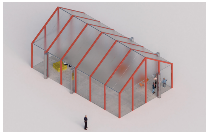
DÆMI 3: Gler hliðar + pólýkarbónat þak
