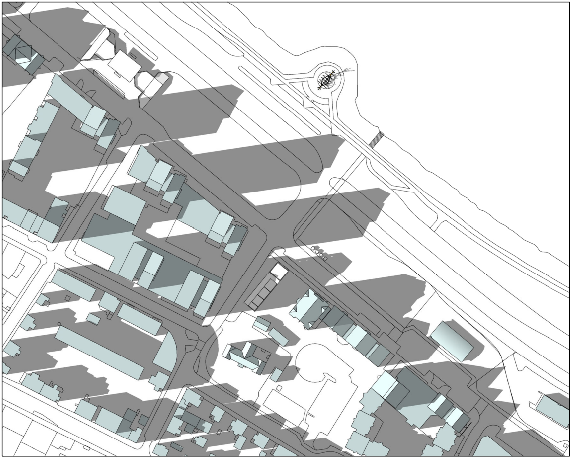
GRUNNMYND - SKUGGAVARP - 21.JÚNÍ KL. 17.00 TILLAGA
