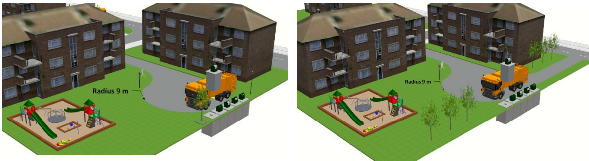
MYND 13 Lágmarksstærð snúningsvæðis fyrir hirðubíl.
